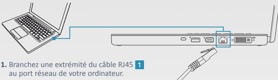
**NB** Le câble RJ45 **1** doit émettre un « clic » très net lorsqu'il est bien connecté.
