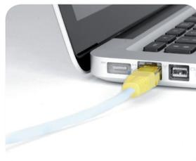
**NB :** Le câble RJ45 (2) doit émettre un «clic» très net lorsqu'il est branché.
