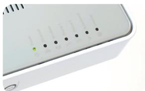
«Power» : la première diode indique le bon fonctionnement du branchement électrique. Le câble d'alimentation est bien branché et fonctionnel.
