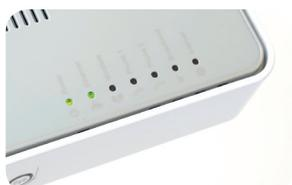
«Ethernet» : la seconde diode indique que le PC est bien connecté au réseau.
